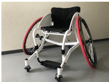
図1 Mg合金製テニス用車いす（東京大会モデル）
