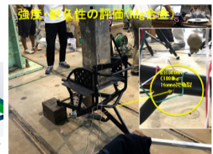
図3 大型材料試験機による破壊試験
