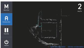
人工衛星の測位による位置情報と、周辺の状況を把握する LiDAR により、走行しながら地図データを AI が自動生成していきます。
