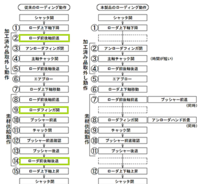
図2 従来と本製品のローディング動作数の比較
