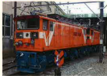
機関車 車両形式: EDV形 (E電気, D4輪, VVVVF)
