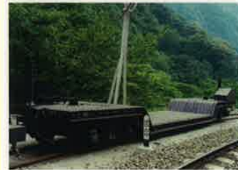
貨物車 車両形式: オシ形 オシ=大型重機物の運搬車
