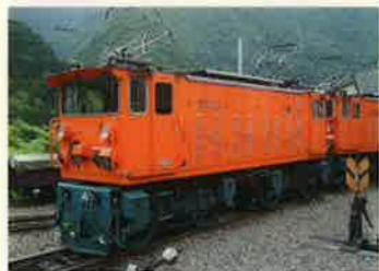
機関車 車両形式: EDR形 (E電気, D4輪, Rリニューアル)
