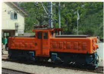
機関車 車両形式: EDS形 (E電気, D4輪, S-sum)
