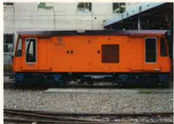
機関車 車両形式: DD形 (Dディーゼル, D4輪)
