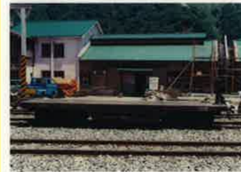
貨物車 車両形式: シ形 シ=重機物の運搬車
