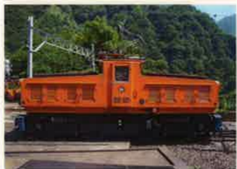
機関車 車両形式: ED形 (E電気, D4輪)
