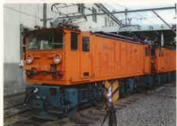
機関車 車両形式: EDM形 (E電気, D4輪, Mモジュール)
