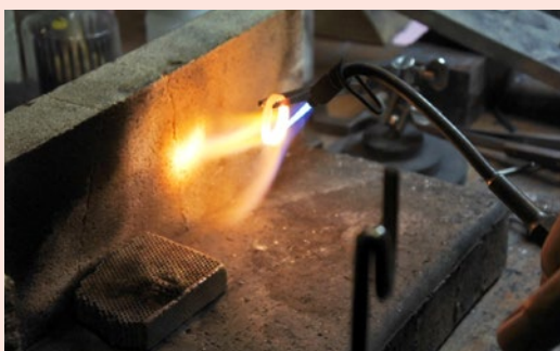
2000℃にもなる高温の炎で、指輪の端をつなげる「ロウ付け」
